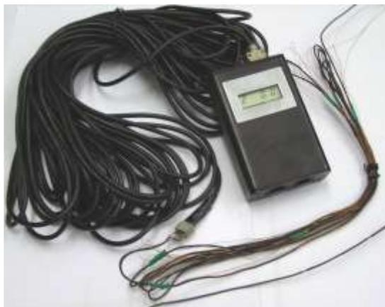
Рис.7 – Измеритель временных интервалов ИВИ-1 и выносной кабелем с датчиками.
