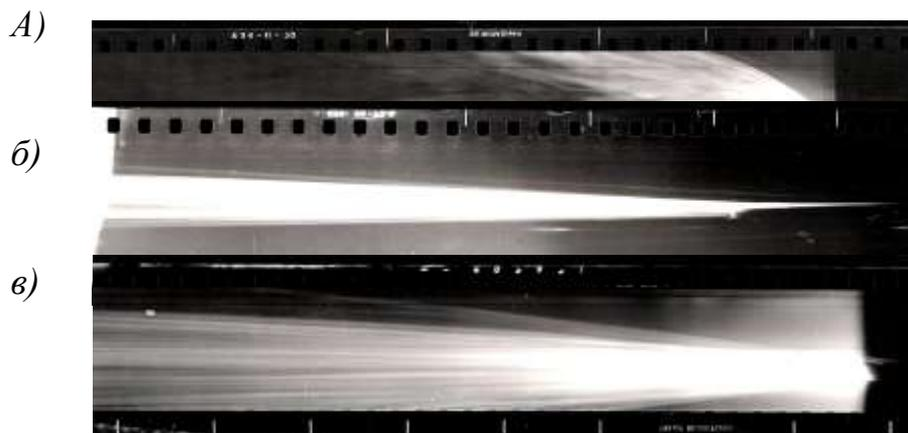
а) поверхность торца заряда ВВ перпендикулярна направлению съемки; б) поверхность торца заряда ВВ наклонена к направлению съемки под углом  $15^{\circ}$ ; в) –  $80^{\circ}$  соответственно
